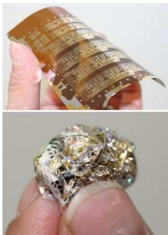
プラスチックフィルム上に作る トランジスタ回路
