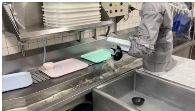
図3 柔軟ロボットハンドによる食器の予備洗浄
